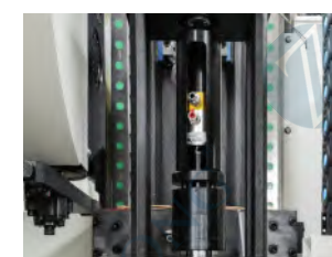
主轴中心出水 Coolant through spindle
